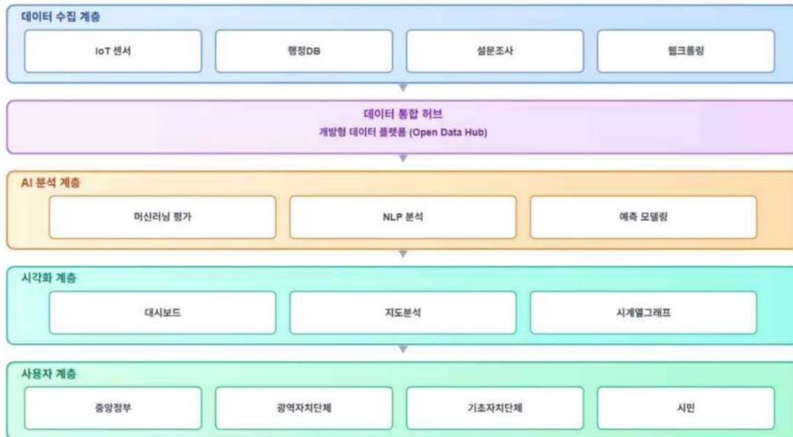
그림1. AI·빅데이터 기반 SDGs 통합 모니터링 시스템 구조도
