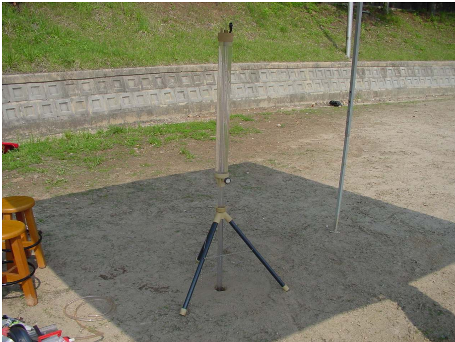
그림 4-6 현장 투수계의 설치
