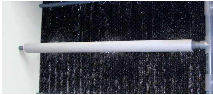
건조 공정 후 배기가스 중 암모니아 및 먼지 제거 공기 세척기(air washing) 5)
