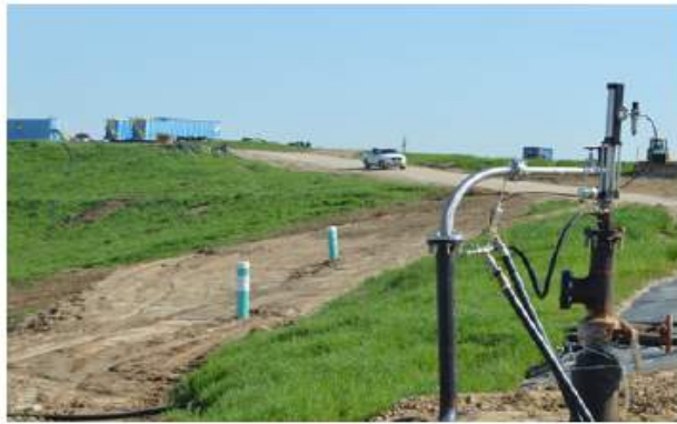
Bridgeton 매립지 온도 모니터링 전극 사진 및 구성도
